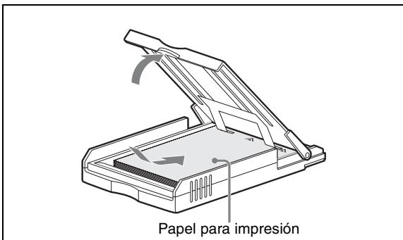
Airee el papel de impresión antes de cargarlo con la superficie de impresión (el lado sin sobreimpresión) orientada hacia arriba. Asegúrese de que la flecha que se encuentra en la lámina de protección apunte en la misma dirección que la flecha de la bandeja. Es posible cargar hasta 25 hojas cuando utilice la serie UPC-X46 o y 30 hojas cuando utilice la serie UPC-X34.
